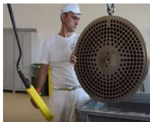
Une matrice en cours de nettoyage à l'IrisBio. Dans chacune de ses ouvertures est insérée une filière. Les pâtes de l'IrisBio sont produites au travers de filières en bronze, sont séchées lentement et sont issues exclusivement de blé dur italien bio.
